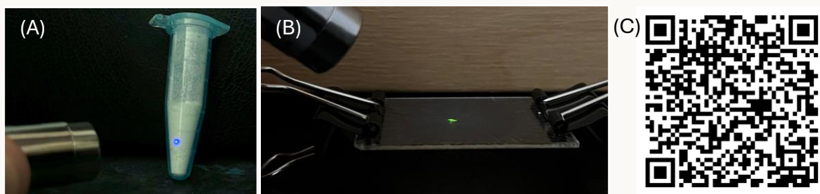
2. ábra: 980 nm hullámhosszú NIR-lézerpointerrel megvilágított (A) túliumadalékolt UCNP-porminta és (B) erbiumadalékolt UCNP-tartalmú, kitozán mátrixanyagú kompozit bevonat, (C) demonstrációs videóanyaghoz vezető QR-kód
